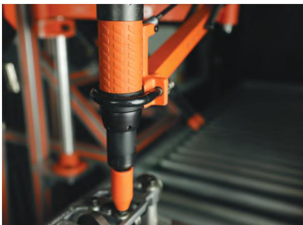
**Das Werkzeugkabel des NeoTek besitzt die erste Viertelumdrehungs-Verriegelung in der Branche** und beseitigt damit eine der häufigsten Ursachen für Schäden am Werkzeugkabel: beschädigte Gewinde. Dank digitaler Kommunikation zwischen Werkzeug und Steuerung hat das Werkzeugkabel statt 28 nur noch 8 Adern, **was einen deutlich geringeren Kabdurchmesser und eine Gewichtseinsparung von 50% ermöglicht.**
